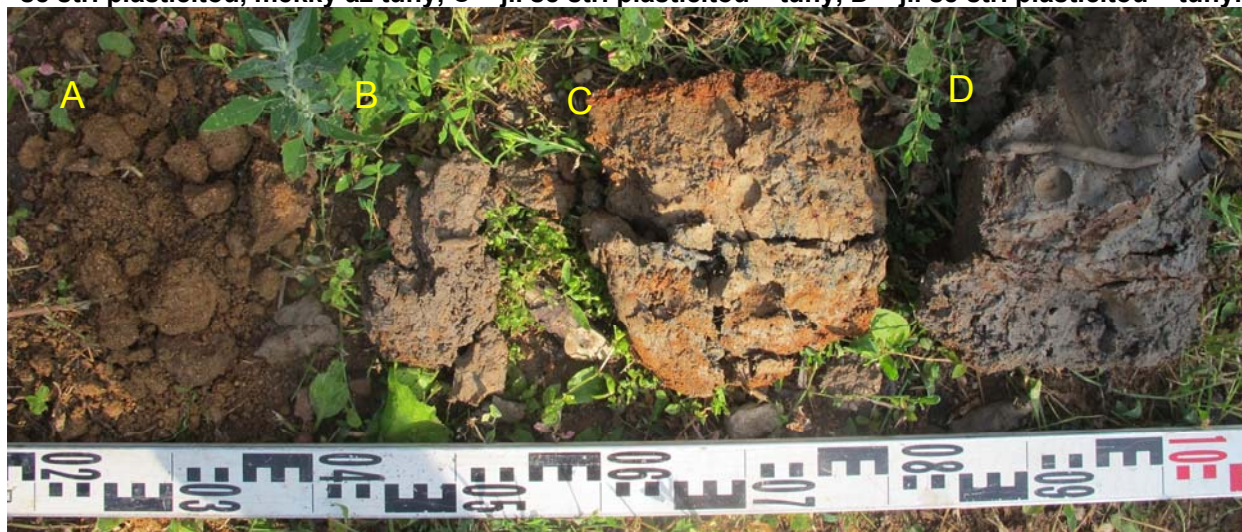
Obr. 3. Charakter zastižených zemin. Vysvětlivky: A - písek jílovitý – přelavené deluvium, B – jíl se stř. plasticitou, měkký až tuhý, C – jíl se stř. plasticitou – tuhý, D – jíl se stř. plasticitou – tuhý.
